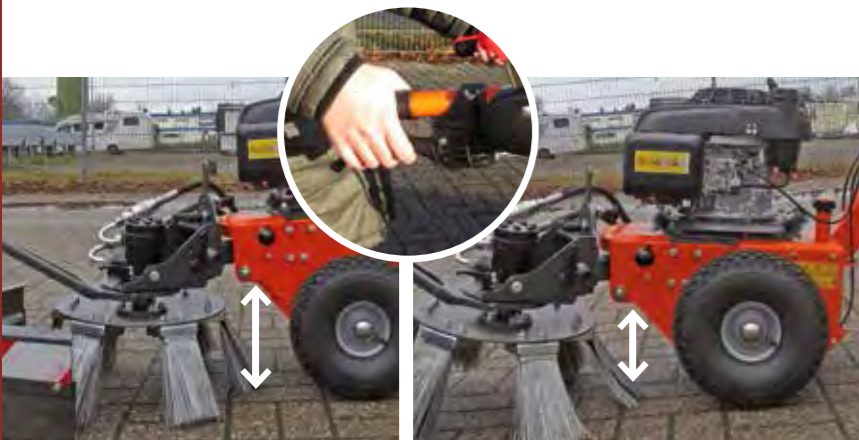
Plynulé výškově nastavitelná osa kol pro kompenzaci opotřebení nástroje.
