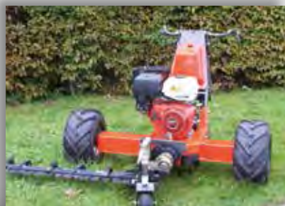
UBS Hydro s rozšířenou nápravou a jednostranným ESM žacím ústrojím
