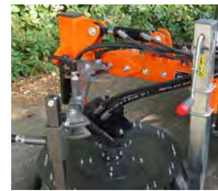
Mechanicky nebo hydraulicky ovládané nastavení pracovního disku
