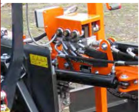
Hydraulický rozvaděč pro hydraulické nastavení pracovních úhlů
