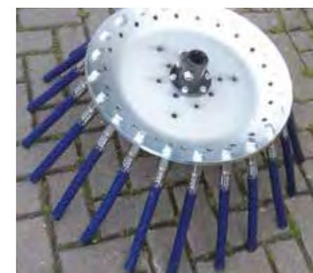
Pracovní disk se svazky drátu potaženého plastem (na přání)
