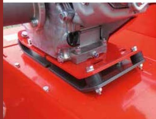
Antivibrační uložení motoru pro snížení vibrací v rukojeti až na  $2,5 \text{ m/s}^2$
