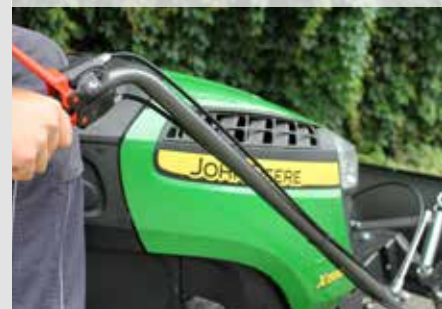
mechanický zdvih a naklápění radlice jednou pákou
