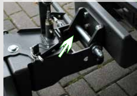
uchycení radlice na jednom čepu
