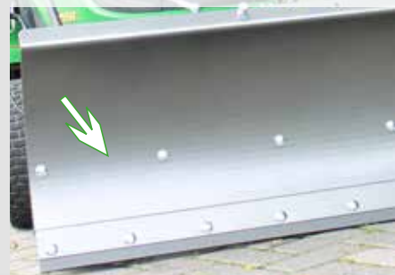
více než třicetnásobné zalomení štítu radlice zaručuje vysokou pevnost
