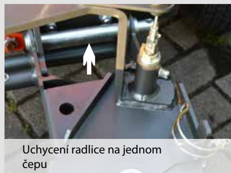
Mechanický zdvih a natáčení radlice jednou pákou
