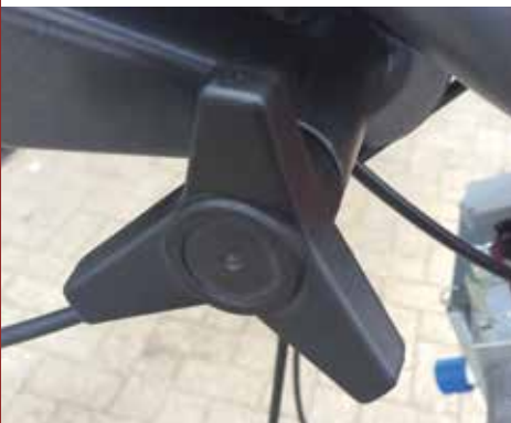
Nastavení sklonu sloupku řízení
