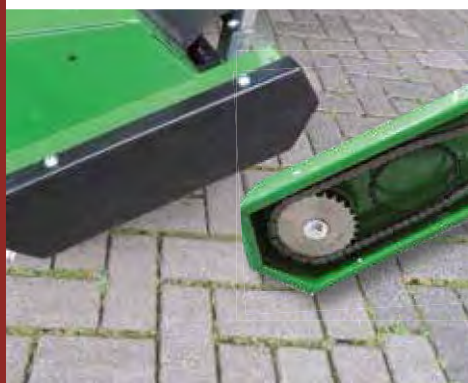
Automatický systém napínání řetězu
