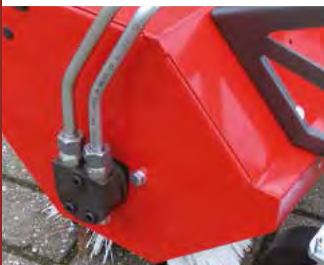
Uvnitř válce uložené hydromotory
