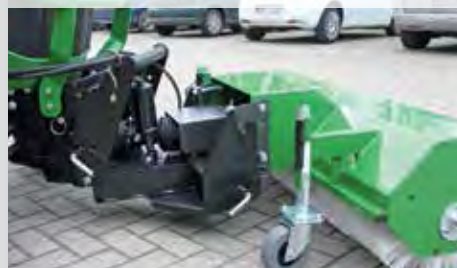
Zametací kartáč poháněný vývodovým hřídelem do závěsu Quick Hitch
