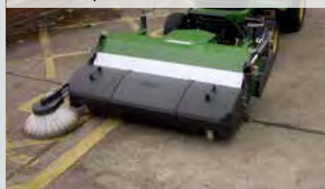
Zametací kartáč se zásobníkem nečistot a bočním přimetacím kartáčem
